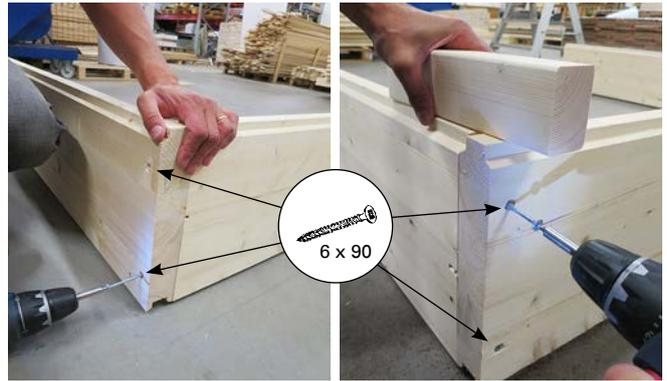
2. Montieren Sie die Wände. Platzieren Sie zuerst die Rückseite und dann die Seiten, und zwar einzeln nacheinander. Schrauben Sie die Teile zusammen und stellen Sie sicher, dass die Oberkante gerade bleibt.
